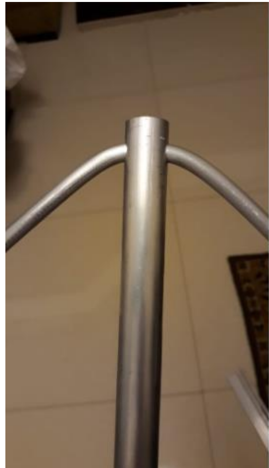
Dipolos com abertura de 90 graus, dobrado a mão e conferido com esquadro 45 graus cada lado.
