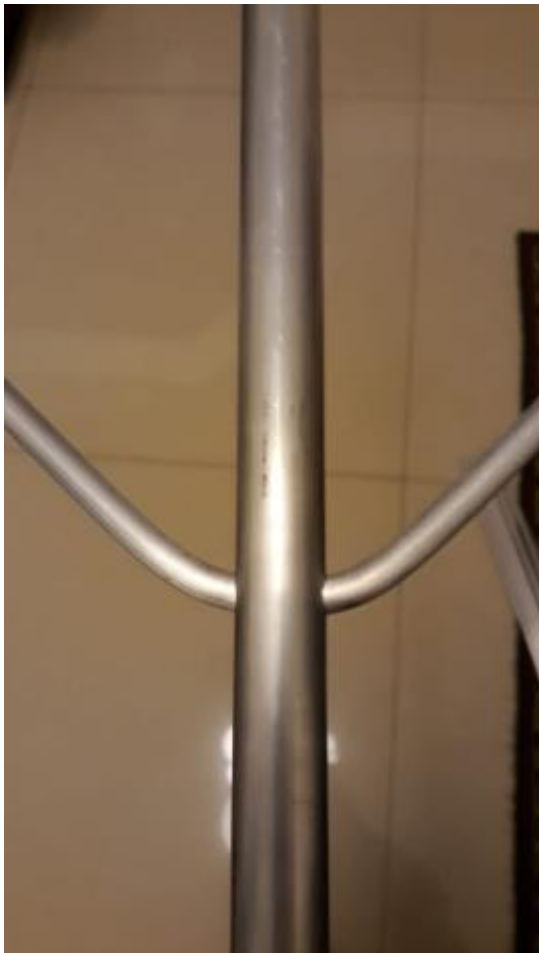
Dipolos com abertura de 90 graus, dobrado a mão e conferido com esquadro 45 graus cada lado.
